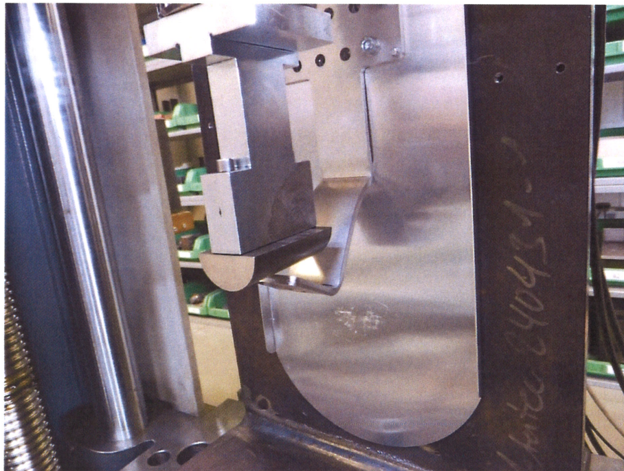
Bild 1: Übersichtsaufnahme des Scherversuches an dem Solar- modulhalter mit Musterstück bei maximaler Verformung von 80 mm
